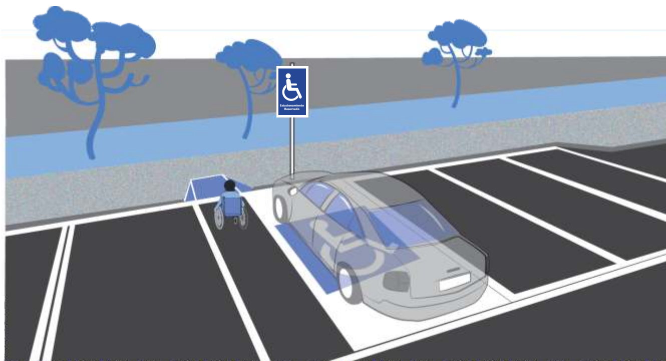
Fig. 21: Ejemplo de señalización del estacionamiento para las Personas con Discapacidad con cartel vertical
