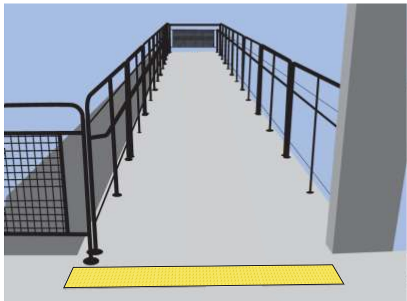
Fig. 35: Ejemplo de piso táctil de alerta ya instalado.
