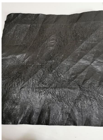
Ilustración 26. Patrón de plegado basado en pandeo torsional.
