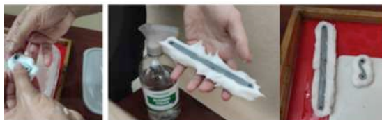
Ilustración 9 Partes replicadas en resina de poliéster
